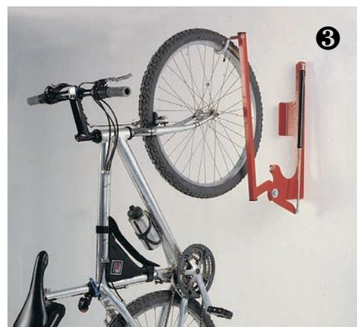
**LIFT** Der Komfortable mit Power. ❶ Rad einhängen, ❷ am Sattel leicht zurückziehen, ❸ Gasfedermechanik löst aus und zieht das Rad in die hängende Position.
